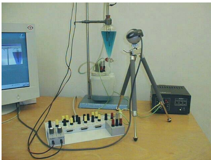
Obr. 2.: Experiment "Řízení výšky hladiny", ovládaný přes internet
