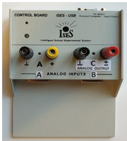
Obr. 2. Panel měřicího systému ISES-USB-IN/OUT, dva vstupní analogové kanály „A“ a „B“ (vzork. frekvence 100 kHz, 12-bit), výstupní analogový kanál „C“ (vzork. frekvence 50 kHz, 12-bit), svorky, multifunkční programovatelný signál.
