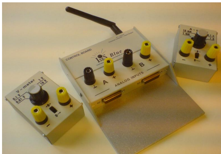
Obr. 1. Bezdrátový měřicí systém ISES Blue se standardními moduly V-metr a A-metr.
