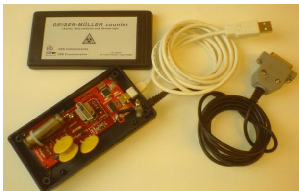
Obr. 2. Geiger Müllerův čítač pro měření radioaktivity (pro ISES, USB, či bluetooth)
