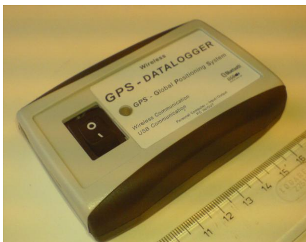
Obr. 5. Modul bezdrátový GPS datalogger (USB a bluetooth)
